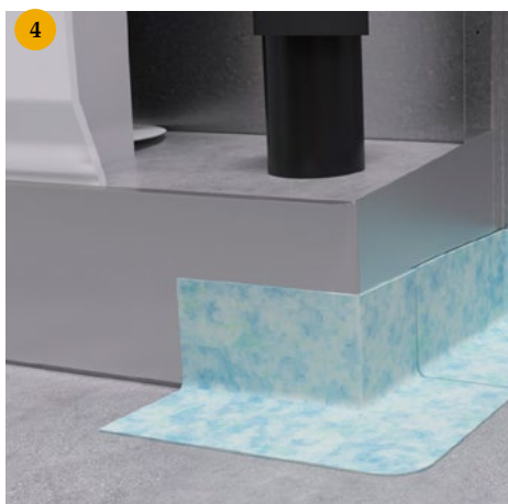
4 Montera medföljande ytter- och innerhorn i det fuktiga skarvlimmet mot golvsockeln. Arbeta bort veck och luftblåsar se till att inga kanaler bildas.
